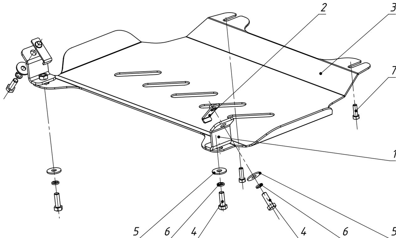
Защита картера (поз.3) крепится в четырех точках и устанавливается только после установки защиты КПП. Для этого необходимо:
